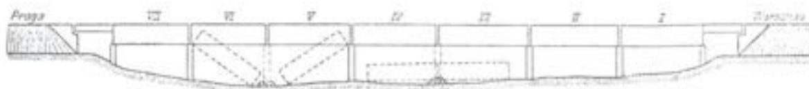
Zniszczenia nowszego mostu pod Cytadelą. Wsadzono czwarty i szósty filar, co doprowadziło do zsunięcia się przęsła trzeciego, czwartego, piątego i szóstego.
