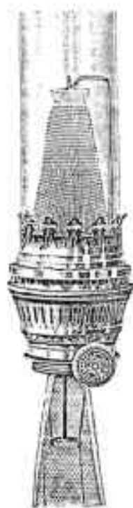
Ilustracja 52. Ziu-Brenner. Jeden z wielu palników naftowo-żarowych z początku XX wieku. Źródło: J. Goldberg, red., op. cit., s. 211.
