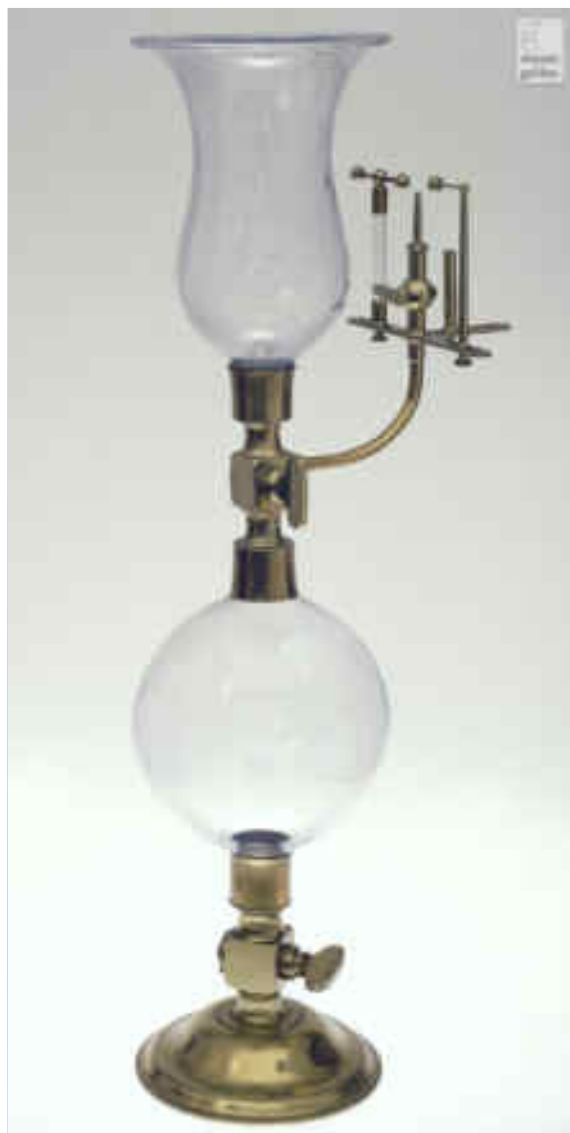
Ilustracja 68. Zapalniczka (lampo-zapalniczka) Volty, ok. 1790. Źródło: Museo Galileo, http://catalogue.museogalileo.it/object/VoltaHydrogenLamp.html , 07.04.2017
