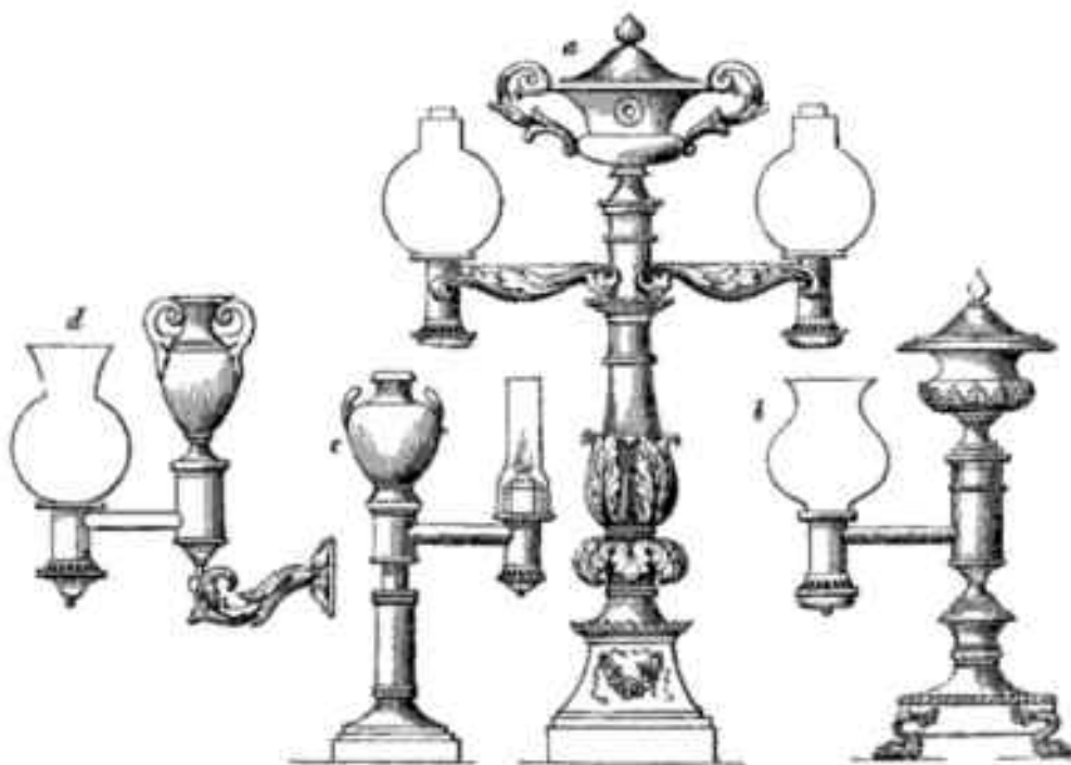
Ilustracja 3. Różne typy lamp argandzkich, wzorujących się na oryginalnych konstrukcjach Arganda. Pochodzenie – początek XIX wieku (należy zwrócić uwagę na występowanie kulistych kloszy, zwężanych szkieł ciągowych oraz spiralnego mechanizmu podnoszenia knota, charakterystycznego dla rynku brytyjskiego – patrz dalej). Kolejno przedstawione typy: a) klasyczna dwuramienna lampa, b) jednoramienna, c) jednoramienna z teleskopową kolumną, d) kinkiet. Źródło: T. Webster, W. Parkes, F. B. Parkes, An encyclopaedia of domestic economy , London 1852, s. 150.
