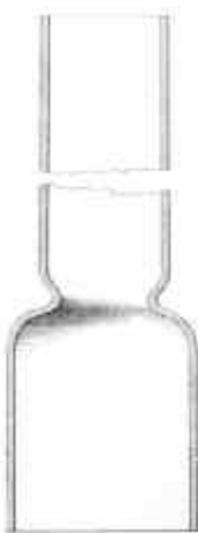
Ilustracja 46. Kształt komina ciągowego stosowanego przy palniku Cosmos . Źródło: W. Kolendo, op. cit., tabl. XXXI, s. n. n.
