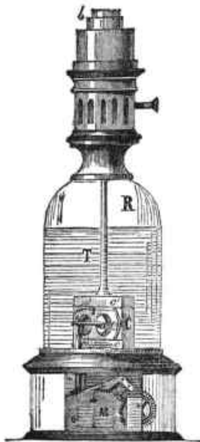
Ilustracja 24. Dwu-tłokowa mechaniczna lampa Carcela. Źródło: F. Wermański, op. cit., s. 14.
