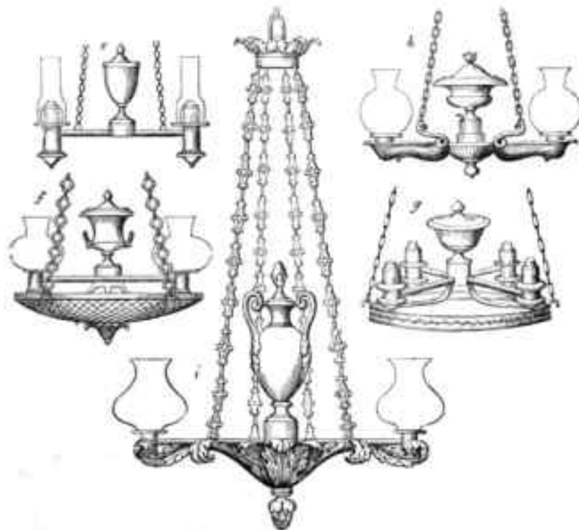
Ilustracja 4. Wiszące lampy typu argandzkiego. Kolejno: e) najprostsza i najtańsza dwupalnikowa lampa wisząca, f) droższa ze szklaną przezroczystą misą ( basin ), zbierającą olej w razie nieoczekiwanego nadmiernego wypływu, g) czteropalnikowa ze szklaną płytą, pełniącą również tę samą rolę zabezpieczającą, h) boat lamp , wyróżniająca się charakterystycznymi kształtami ramion w kształcie łodzi, i) ekskluzywny model o wyjątkowo bogatej ornamentyce. Źródło: T. Webster, W. Parkes, F. B. Parkes, op. cit., s. 151.
