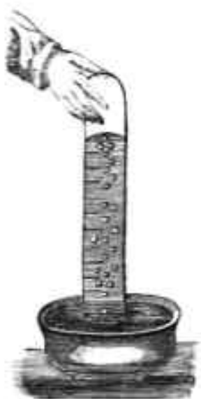
Ilustracja 60. Najprostsza metoda badania jakości nafty, poprzez sprawdzenie ilości wydawanych gazów zbierających się u góry kolby. Źródło: [b. aut.], Próba nafty , „Przyroda i Przemysł”, 1872, r. 1, s. 132.
