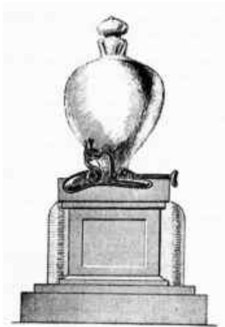
Ilustracja 75. Thermolampa, a właściwie jeden z jej elementów - palnik grzewczy składający się z postumentu skrywającego palnik oraz klosza radiacyjnego. Źródło: H. R. d'Allemagne, op. cit., Paris 1891, [w:] W. Schivelbusch, op. cit., s. 22.
